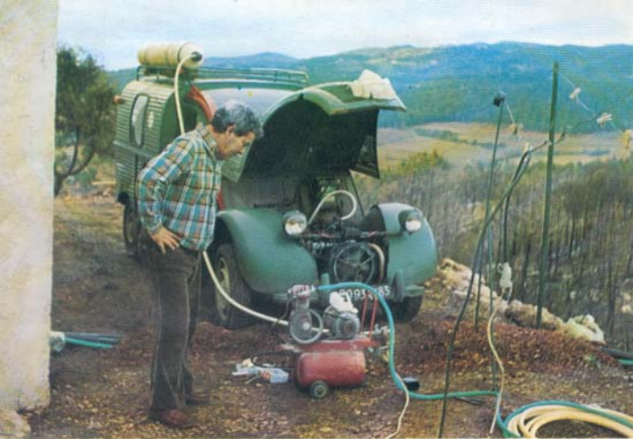
Opération délicate: la compression du Gaz vers la bouteille-réservoir.
