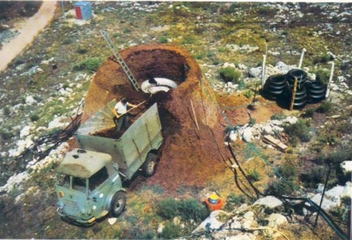
Rechargement manuel de la cuve de production de Gaz de Broussailles. (aujourd'hui effectué, ainsi que la vidange, par pompe automatique de notre conception).
